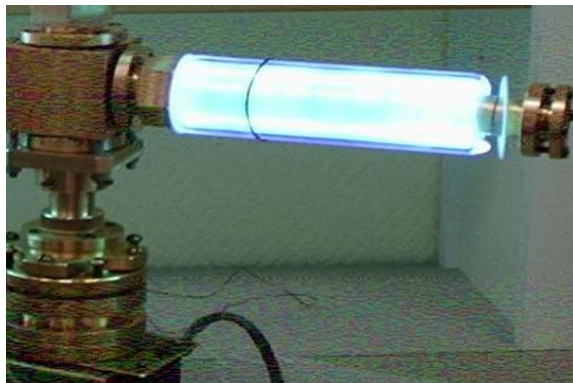
Рис.10. Фотография газоразрядного источника оптического излучения в рабочем состоянии
